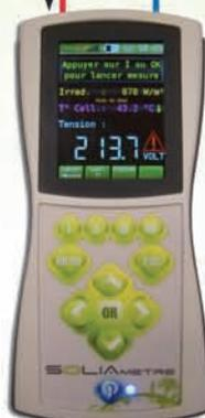
Les mesures sont effectuées sur un ou plusieurs modules en série et/ou parallèle.
